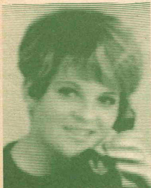
Fig. 3 - Una fotografia di un'immagine in SSTV, con esposizione della durata di 8 sec, permette di osservarne la buona linearità.
